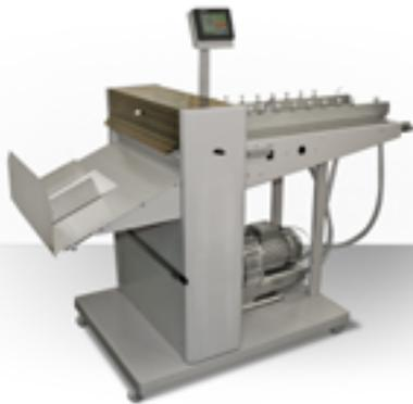
Durch einen Kompressor und Druckluft werden die verarbeiteten Materialien mit Luft aufgefächert. Die Perforiereinheit ist integriert. Mit Touch-Screen-Bedienung und der Speicherung verschiedener Programme.
